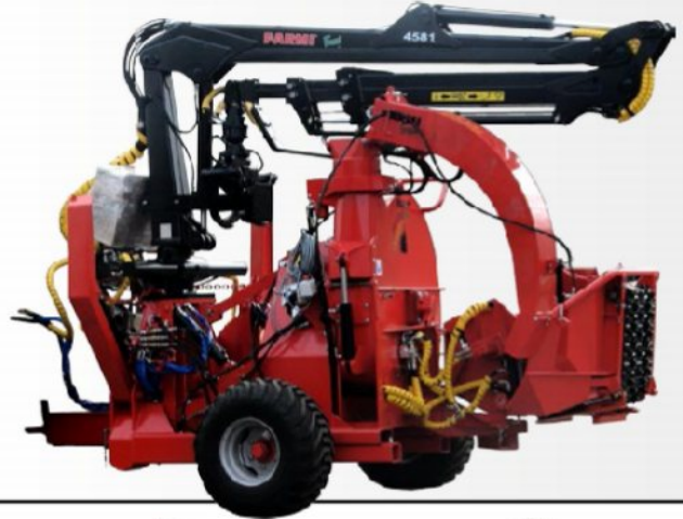
Дробилка CH 260/381и манипулятор FARMI на прицепе T5000
