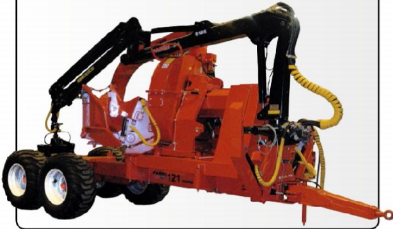
Дробилка CH 381 HFC и манипулятор FARMI на прицепе VARIO 121
